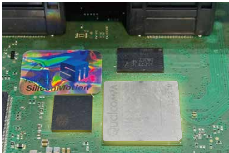
图 3：搭载 Ferri-UFS 的 Qualcomm 车用平台
