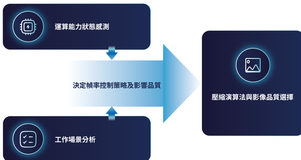
圖 2：CAT™ 2.0 智能模組可在運行時動態選擇最佳壓縮演算法，以提升使用者體驗。
